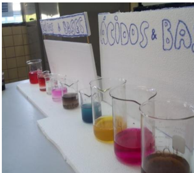
Figura 3 - Identificação de Substâncias ácidas e básicas com uso de indicadores de Repolho Roxo, Fenolftaleína e Açai
