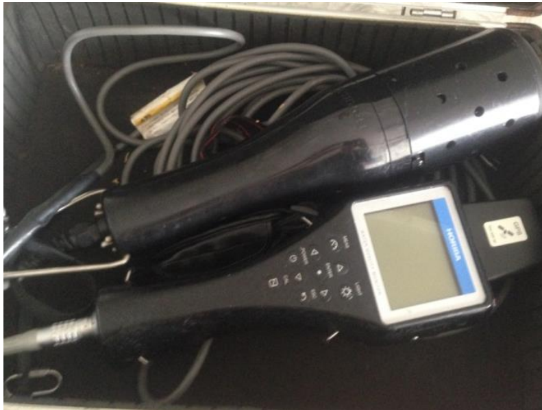
Figura 1 – sonda multiparâmetros U – 50, utilizada para fazer análise físico-química da água dos bebedouros.
