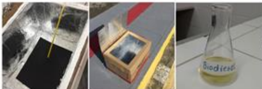
Figura 01 – Visualização interna do forno solar, a reação em exposição ao sol e o biodiesel produzido
